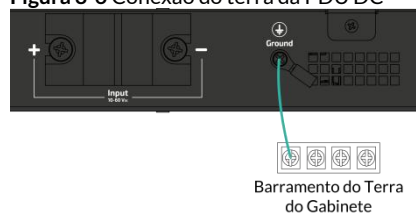
Figura 3-6 Conexão do terra da PDU DC
